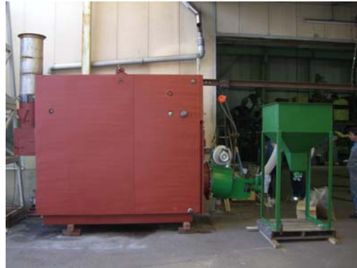
【木質・牛糞燃焼 温水缶】 Joule-R20 200,000kcal/h
